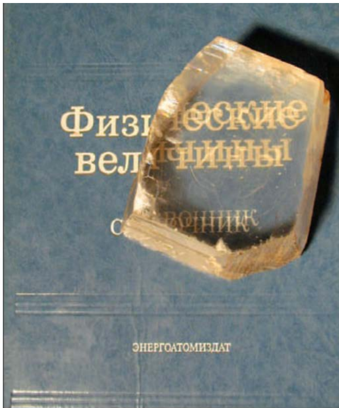
Рис. 19.1. Двойное лучепреломление в кристалле кальцита
